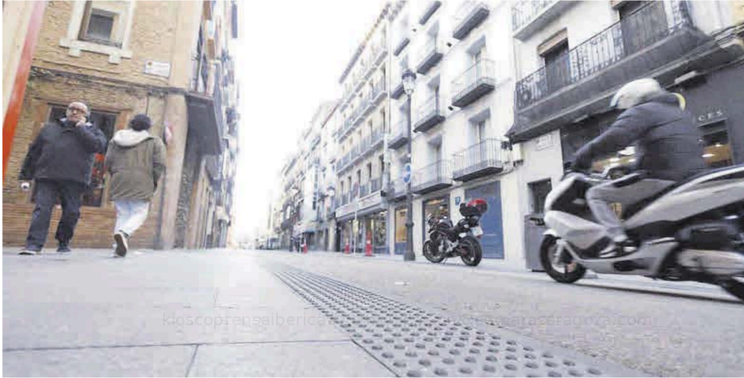
Vista a ras de suelo de la calle Manifestación, recientemente reformada para que sea de plataforma única.
